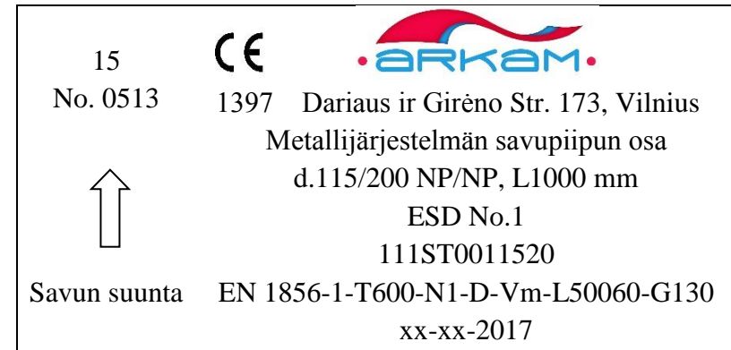
Kuva.1. Esimerkki tuplaseinäisen savunpoistojärjestelmän osien tunnistamisesta
